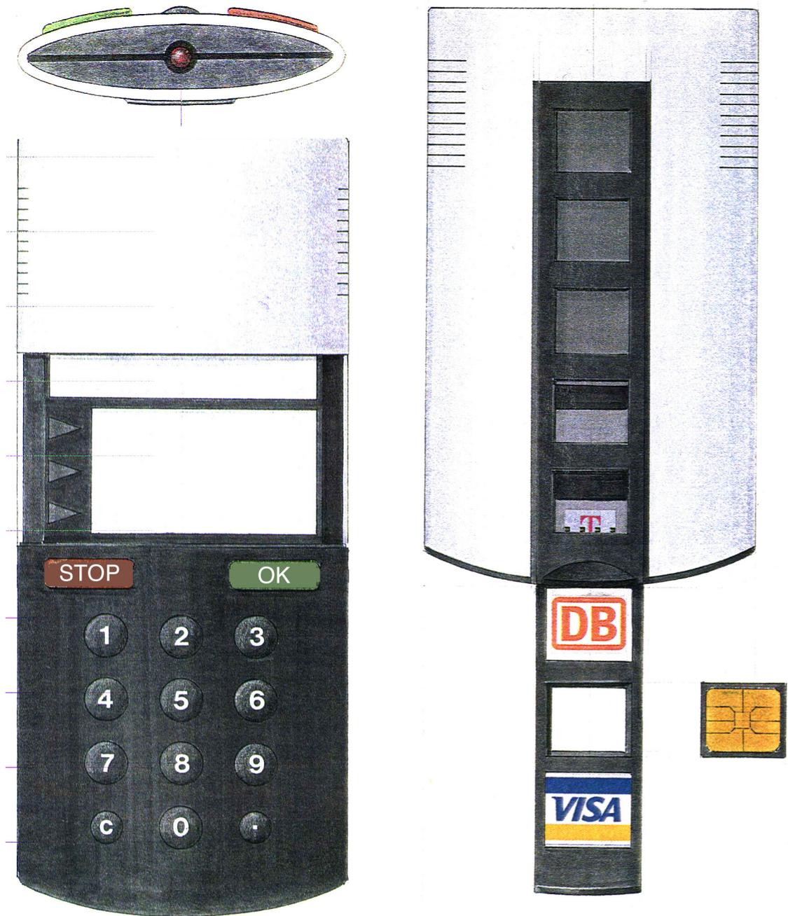
Abb. 1: Designstudie für eine multifunktionale Brieftasche mit Infrarotschnittstelle, Menütasten und Schublade für mehrere Sicherheitsmodule (Özalp 1996).
