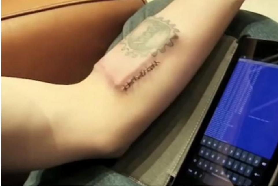
Das **Circadia - Impantat** misst Körperdaten wie Temperatur und gibt über LEDs Feedback an den Träger. Es kann die protokollierten Daten über Bluetooth freigeben und wird über Induktion geladen.
