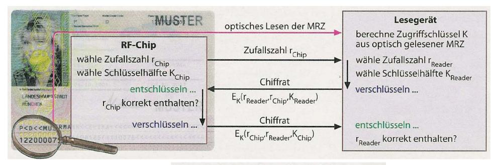
Das Lesegerät muss sich gegenüber dem RF-Chip auf den neuen Ausweisen authentisieren. Dafür benötigt das Lesegerät einen geheimen Zugriffsschlüssel, der sich aus der maschinenlesbaren Zone des Reisepasses berechnet.
